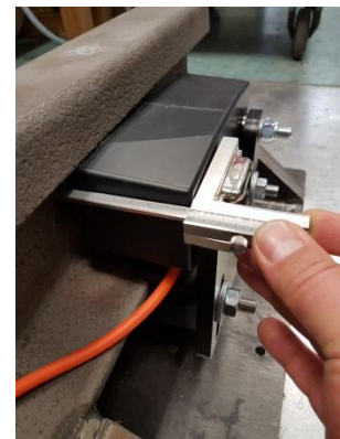
Abbildung 7: Abstand Radsensor zu Schienensteg
